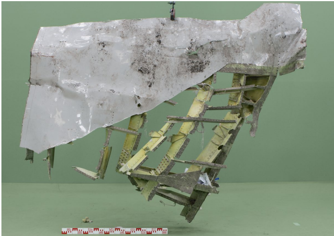
Figuur 25: Typisch geval van scheiding van de huid en de onderliggende constructie. De huid is losgetrokken van de langsspanten en frames. (Bron: Onderzoeksraad voor Veiligheid)
