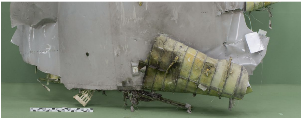
Fiiguur 24: Voorbeeld van buigen/lostrekken bij een breuklijn die te maken heeft met de uiteindelijke scheiding van twee wrakstukken. (Bron: Onderzoeksraad voor Veiligheid)
