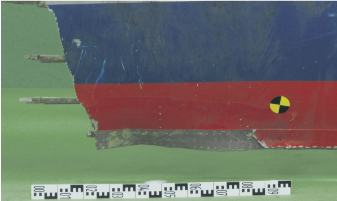
Fiiguur 23: Typisch geval van breuk in de lengtenaad als gevolg van lostrekken, in het rechterdeel van de figuur. (Bron: Onderzoeksraad voor Veiligheid)
